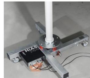
**DAMPED CAPACITIVE VOLTAGE DIVIDERS**
